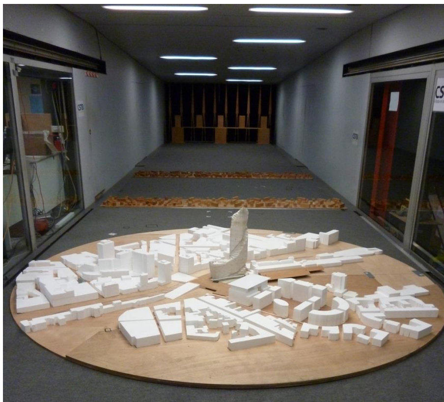
Maquette au 1/250 ème qui a été réalisée dans le cadre de l'étude de l'action du vent sur le bâtiment
