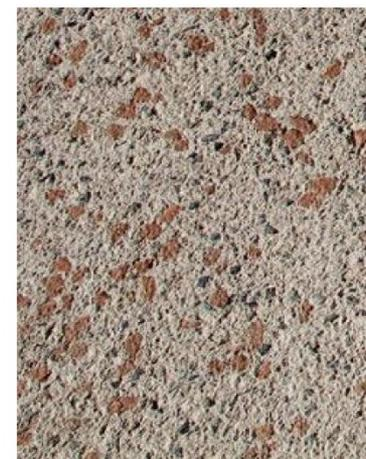
Béton avec agrégats de briques concassés
