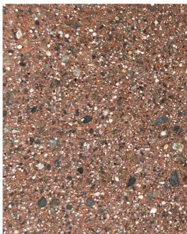
Béton avec agrégats de briques concassés
